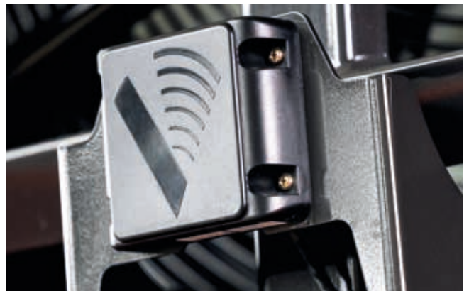
Außerdem erhöht das Hinderniserkennungssystem am Heck die Sicherheit auf der Baustelle.
