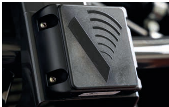
Außerdem erhöht das Hinderniserkennungssystem am Heck die Sicherheit auf der Baustelle.
