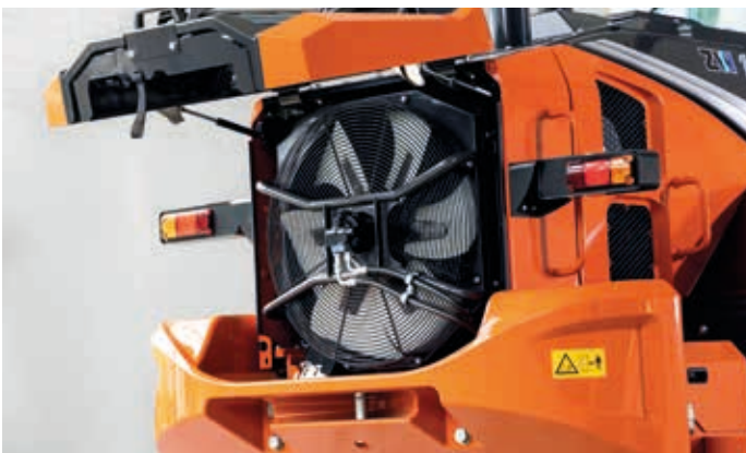
Das intelligente Lüftersystem verhindert ein Verstopfen der Kühler.
