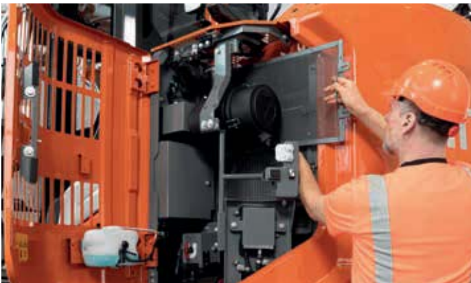
Die vergrößerte Kühlerabdeckung (ZX135US-7) bietet einen einfachen Zugang für die Reinigung und Wartung.
