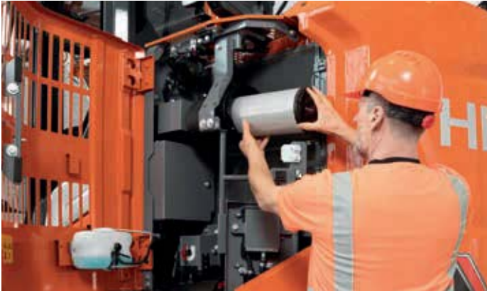
Große Wartungszugänge vereinfachen den Filterwechsel.
