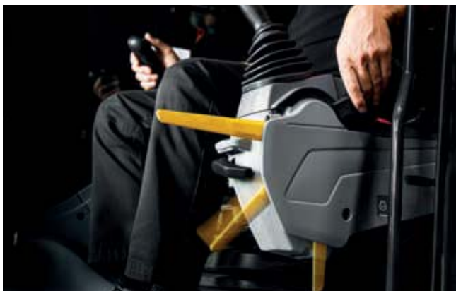
Der Vorsteuerabsperrhebel bietet mehr Sicherheit in der Kabine.
