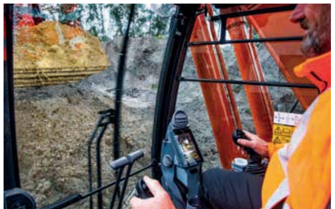
Die größere Wischfläche der parallelen Scheibenwischer verbessert die Sicht bei schwierigen Arbeitsbedingungen.
