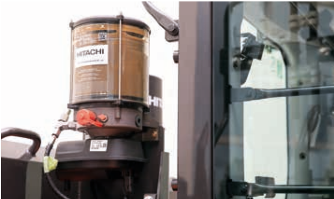
Die Zentralschmieranlage trägt zur Senkung der Wartungskosten bei.
