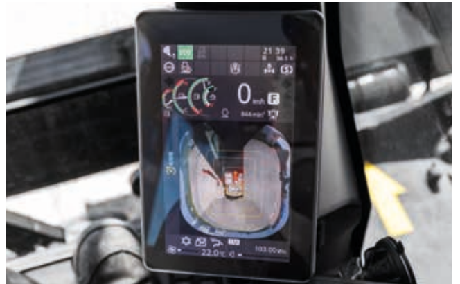
Der 8-Zoll-LCD-Farbmonitor ist dank des hochauflösenden und entspiegelten Bildschirms sehr gut ablesbar.
