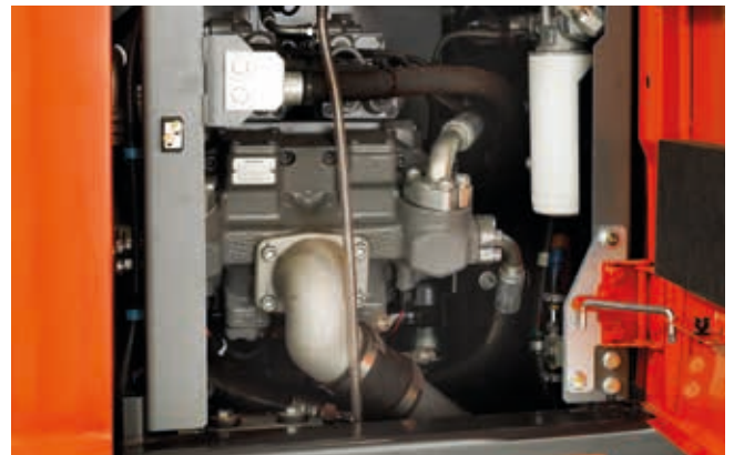
Beim ZX150W-7 und ZX155W-7 werden dank des neuen Hydrauliksystems HIOS V bis zu 5 % Kraftstoff eingespart.
