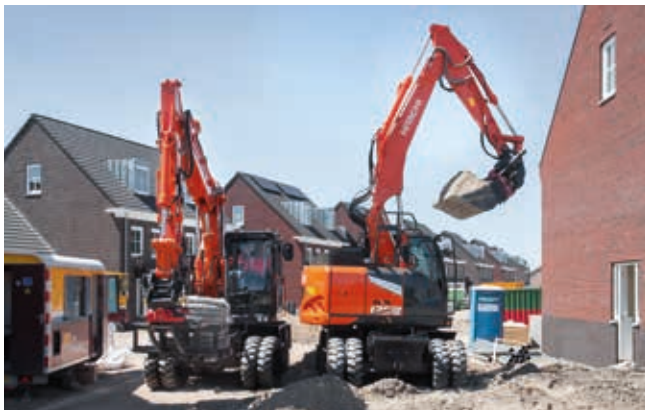
Durch den geringen Schwenkradius eignet sich der ZX135W-7 ideal für Arbeiten auf engstem Raum.
