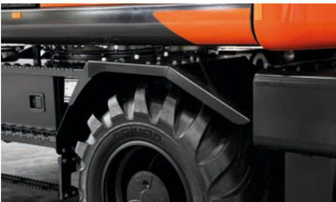
Die Kotflügel am Unterwagen schützen den Oberwagen sowie die Scheinwerfer vor Verschmutzung. Dadurch bleibt die Maschine sauber.
